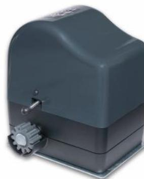
Motorreductor para puerta corredera de hasta 600 kg. Uso residencial. Incorpora el cuadro de maniobras, con sistema antiplastamiento para invertir la maniobra en caso de detección de obstáculos. Desbloqueo a llave personalizada en caso de falta de alimentación. Velocidad de hoja: 10m/min.
